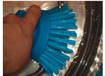
Zur Grundreinigung gehört auch das Säubern der Saug- bzw. Drucköffnungen. Nach dem Reinigen der Heizspirale, Behälterinnenwand und der Saug- bzw. Drucköffnungen, entleert man den Braumeister und spült den gesamten Behälter nochmals aus.
