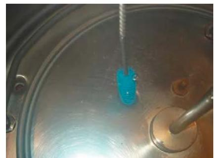
Nun erfolgt das Reinigen der Pumpe. Pumpe öffnen. Pumpengehäuse sollte von Hand zu öffnen sein. Sollte dies nicht der Fall sein, bitte mit kleinem Kantholz und Hammer die Überwurfmutter lösen.
