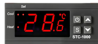
Temperaturregler: Sollwert bei Wasserbetrieb auf 2 °C setzen.
